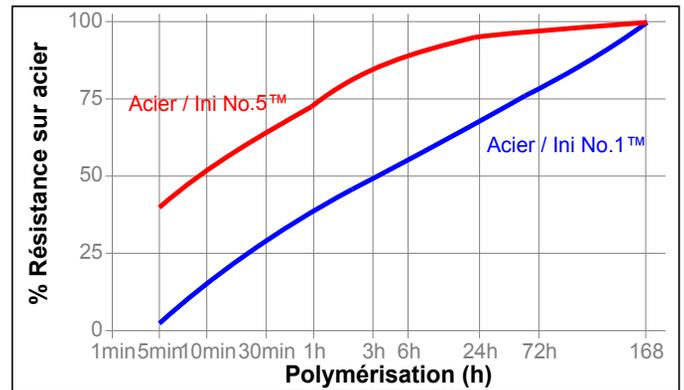
Le graphe ci-après montre l'évolution de la résistance au cisaillement développée en fonction du temps sur PVC, test selon ISO 4587
